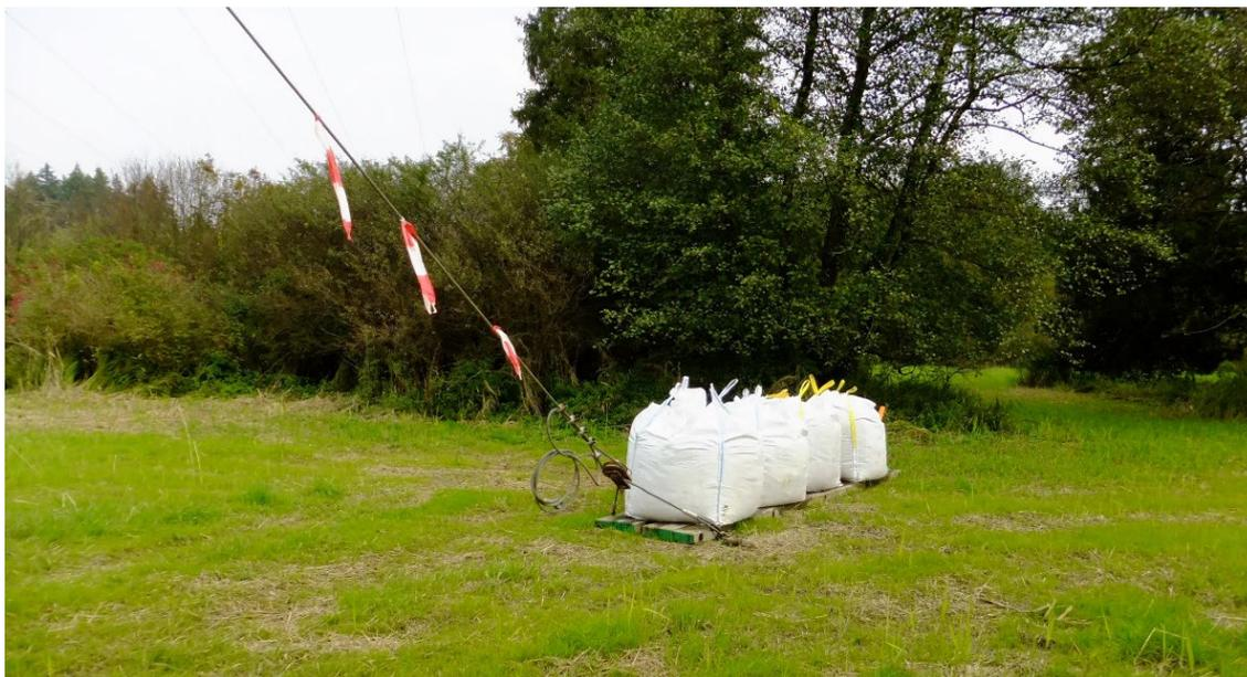
Abbildung 13: Abankerung mittels Ballastschlitten
